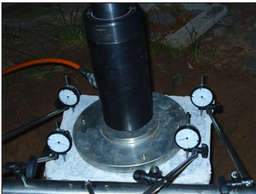
Figura 7 - Defletômetros instalados no bloco de coroamento da estaca.
