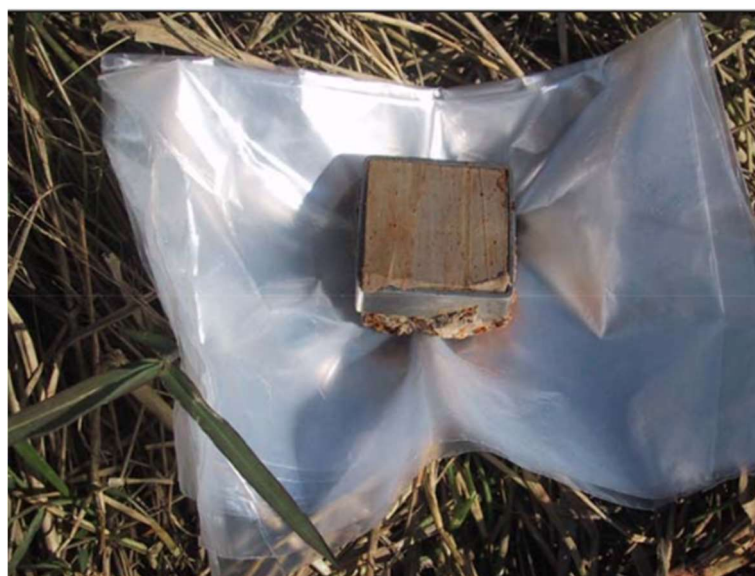
Figura 15 - Retirada de amostra indeformada no CEEG-UFSM.
