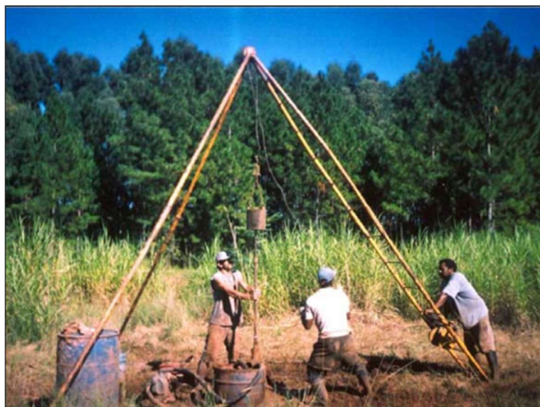
Figura 13 - Execução de sondagem de simples reconhecimento no CEEG-UFSM.
