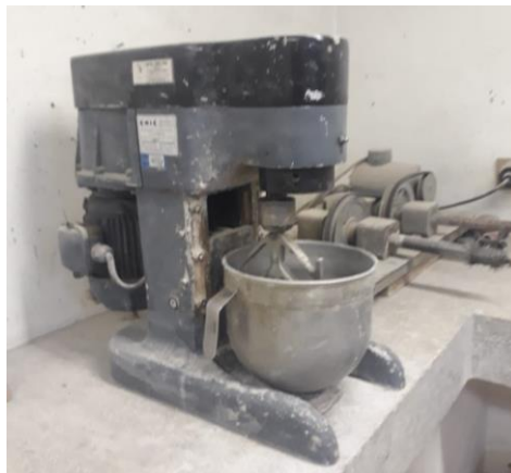
Figura 15 - Misturador de eixo vertical com capacidade de 5 litros e com movimento planetário utilizado para o preparo da pasta à base de EGAF
