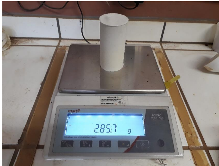
Figura 20 - Pesagem dos CPs antes da secagem em estufa
