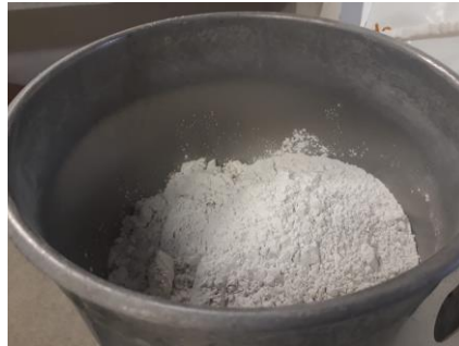
Figura 14 - EGAF dentro da cuba da argamassadeira para o preparo da pasta de EGAF
