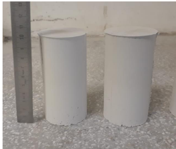
Figura 18 - Corpos de Prova à base de pasta de EGAF após moldagem e compactação
