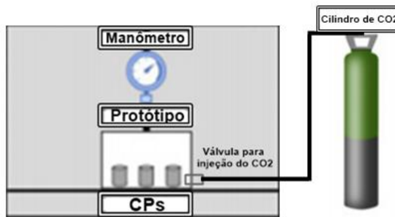
Figura 22 - Câmara em funcionamento durante o processo de carbonatação dos CPs de Escória
