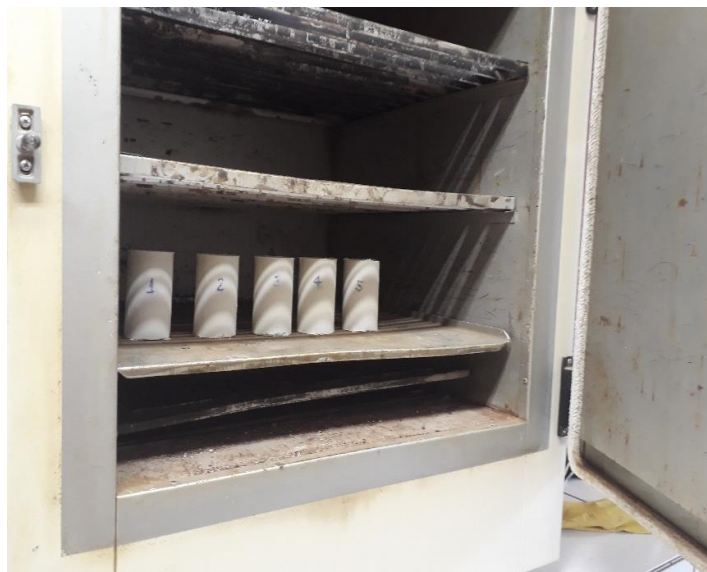
Figura 21 - CPs à base de pasta de EGAF colocados na estufa para reduzir o teor de umidade
