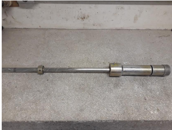
Figura 17 - Soquete utilizado para compactação da pasta à base de EGAF para o preparo dos CPs 5X10 cm
