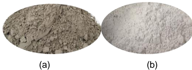
Figura 13 – Comparação visual (a) cimento Portland CP-IV 32 e (b) EGAF moída
