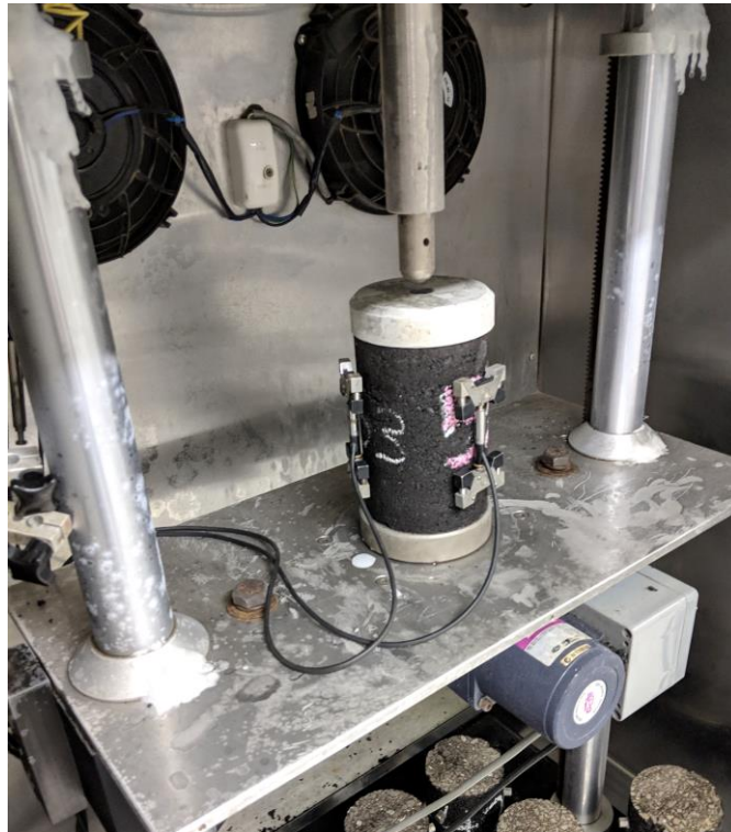
Figura 14 - Ensaio de módulo dinâmico
