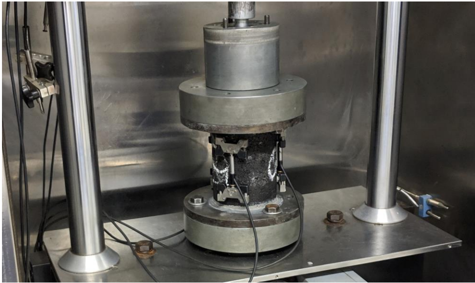
Figura 15 - Ensaio uniaxial cíclico de tração compressão na prensa UTM-25
