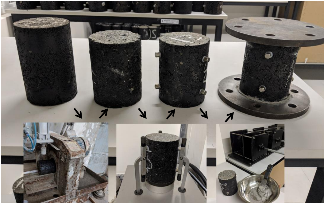
Figura 16 - Preparação amostras ensaio de fadiga
