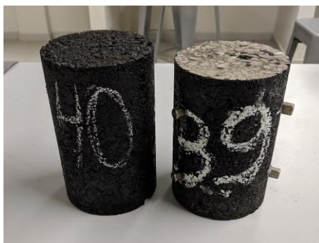
Figura 13 - Preparação amostras módulo dinâmico
