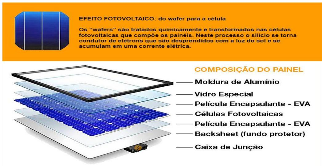
Na **construção do Painel Solar Fotovoltaico**, cada célula fotovoltaica é colocada, de forma plana, em série, uma após a outra.
