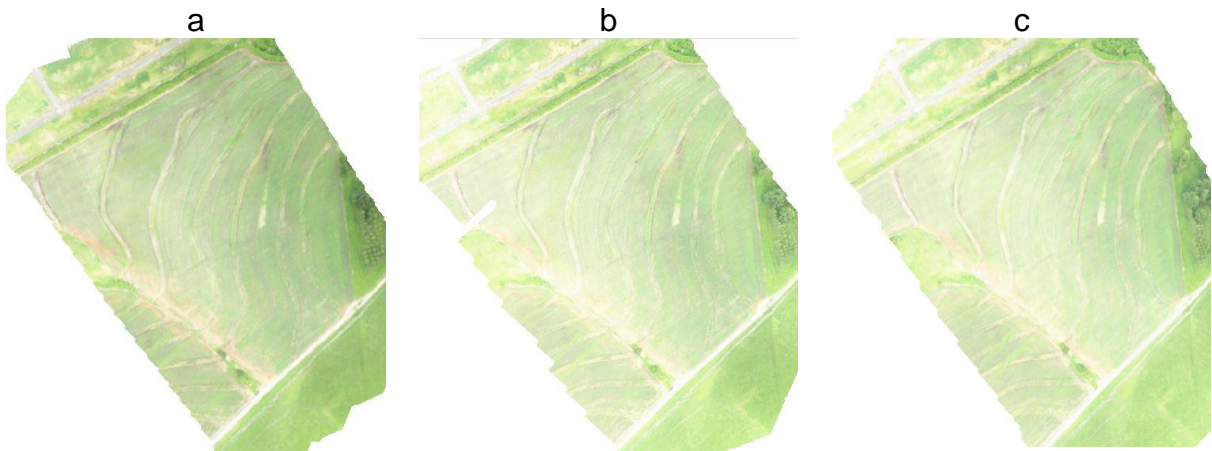
Figura 18 - Mosaico ortoretificado dos voos realizados em 05/01/2019, nas alturas de voo a) 60m, b) 90m e c)120m.
