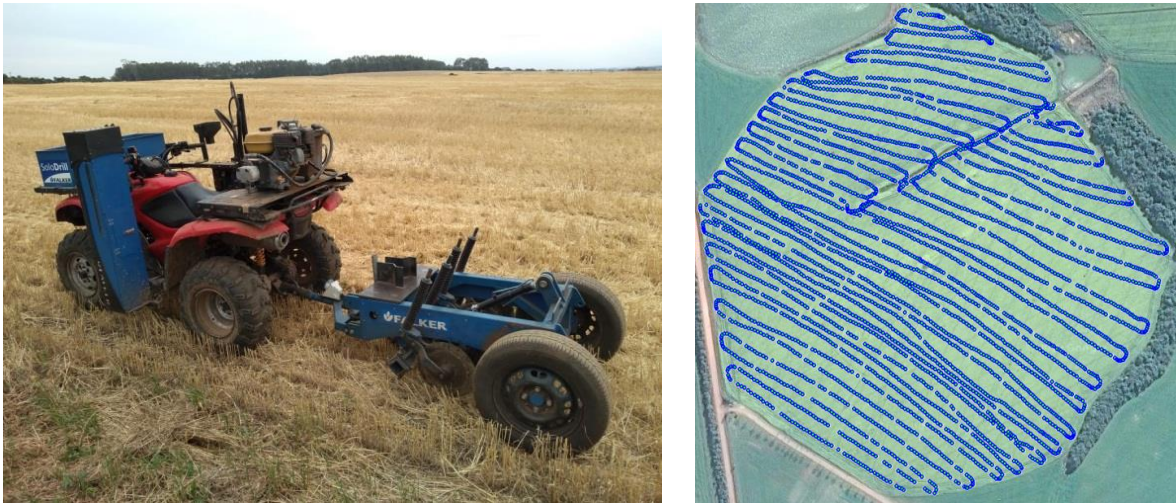
Figura 3 – Conjunto quadriciclo e Terram (A) e mapa de pontos de leitura da CE do solo (B). Fonte: Autor
