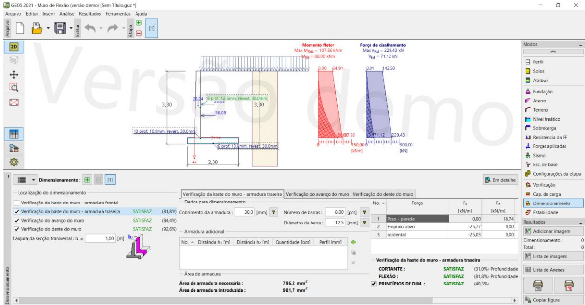
Figura 3.18- Apresentação do dimensionamento das armaduras - GEO5
