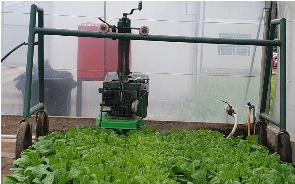
Apêndice 3– Tripé para condução da máquina de podar mudas.
