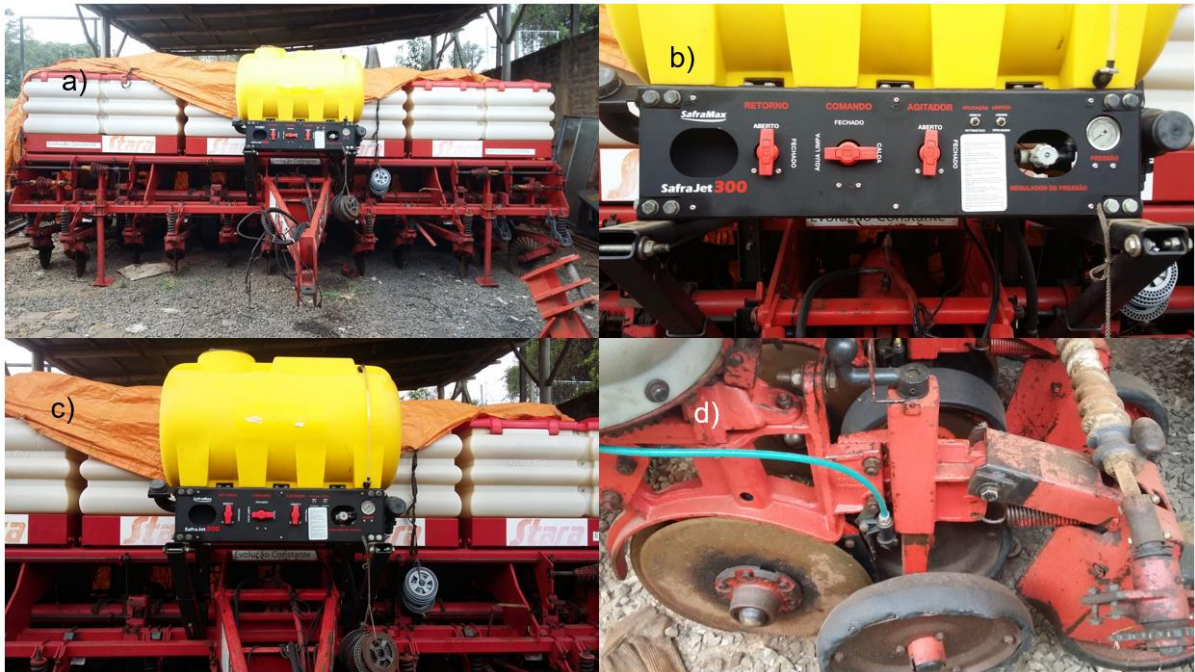
Figura 17 – Equipamentos utilizados no plantio, sendo: a) Semeadora, b) detalhes do painel de comandos c) Pulverizador de jato no sulco da sementeira e, d) sistema de mangueira que leva o líquido até o sulco da sementeira.
