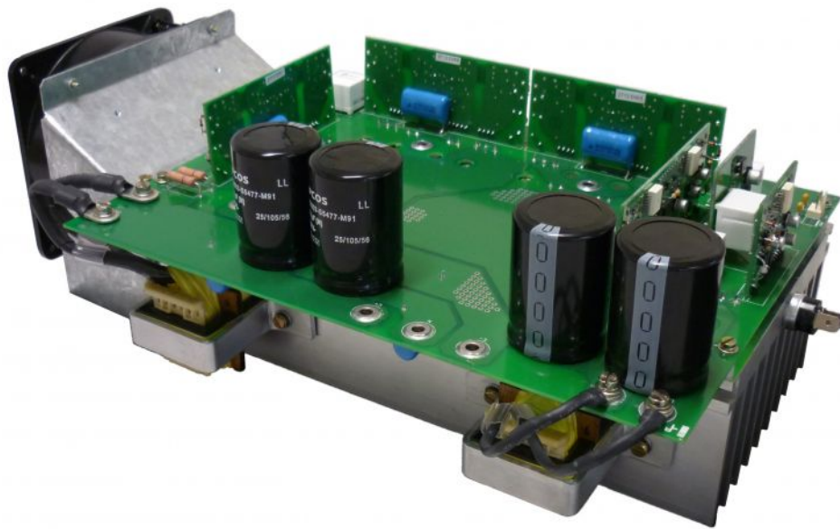
Figura 14 – Conjunto Inversor trifásico de 4 braços Supplier.
