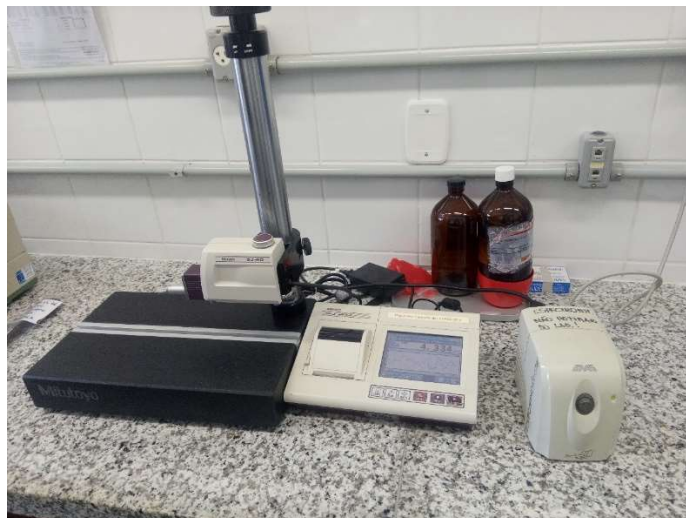
Figura 8 - Rugosímetro de bancada utilizado para a avaliação do parâmetro Ra do perfil de rugosidade.
