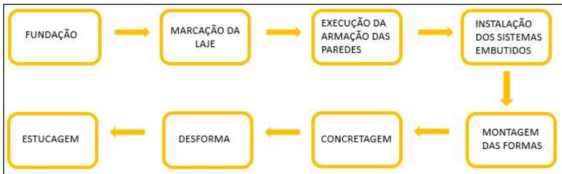
Figura 8 – Sequência Executiva do Sistema Paredes de Concreto Moldado in loco .
