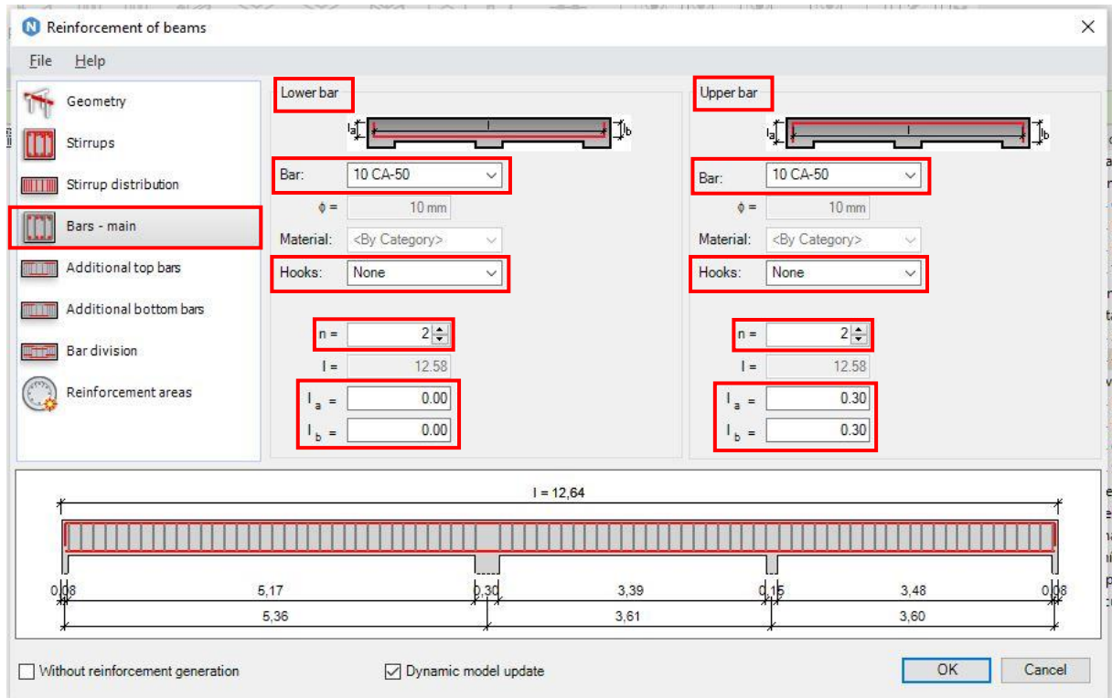
Figura 91 – Detalhamento armadura longitudinal da viga.
