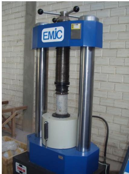
Figura 3.3 – Ensaio de resistência à compressão axial
