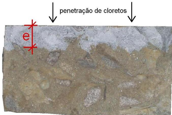
Figura 3.7 – Medição da penetração de cloretos pós ensaio da ASTM C1202
