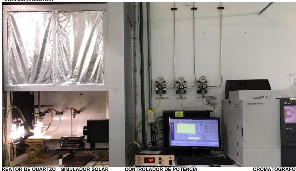
Figura 12 - Sistema utilizado no experimento de aplicação dos compósitos 1A a 5A como fotocatalisadores.
