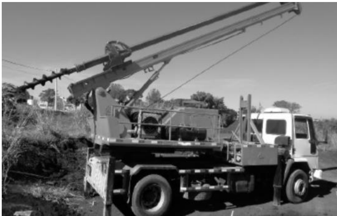
Figura 5 – Trado Mecânico para estaca escavada
