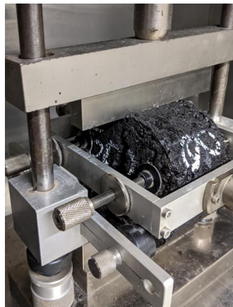
Figura 32 - Ensaio de fadiga à compressão diametral
