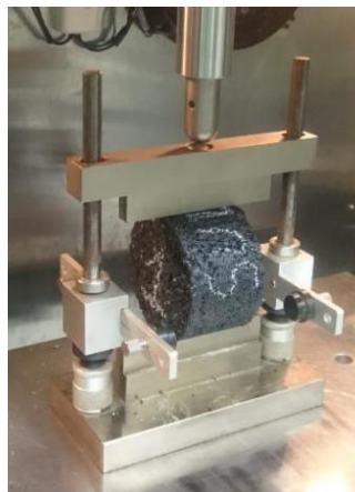
Figura 31 - Ensaio de resistência a tração por compressão diametral
