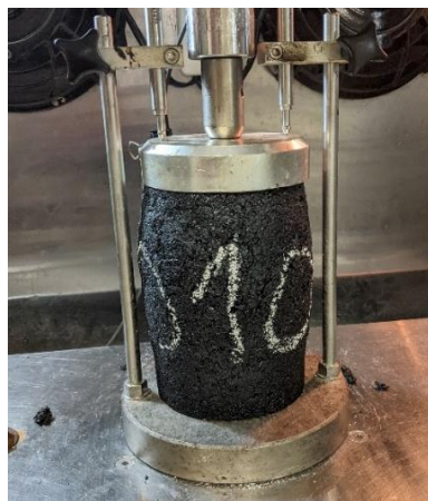
Figura 30 - Ensaio de Flow Number na amostra
