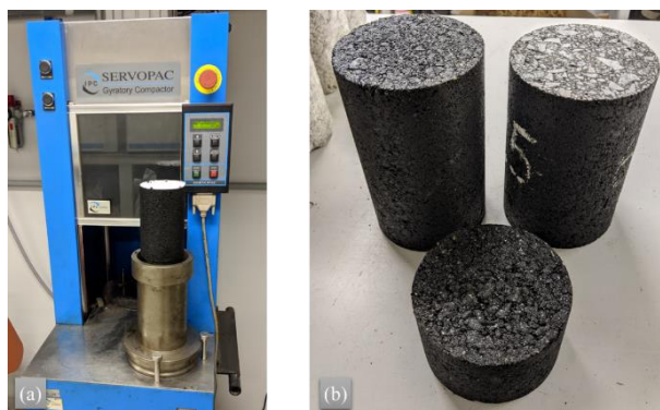
Figura 26 - Preparação da amostra: (a) Compactador giratório; (b) Amostra retificada
