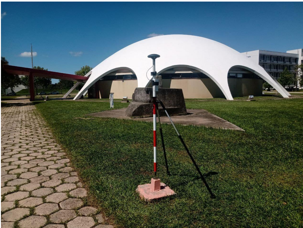
Figura 14 - Receptor Polaris S100 instalado sobre o marco M031
