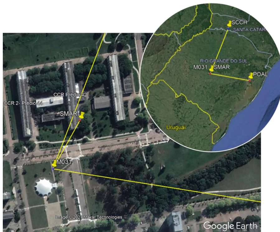
Figura 13 - Linhas de base formadas com estações do sistema geodésico brasileiro
