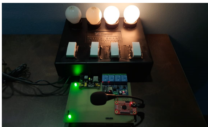
Figura 28 – Protótipo de reconhecimento de voz com duas lâmpadas acionadas.
