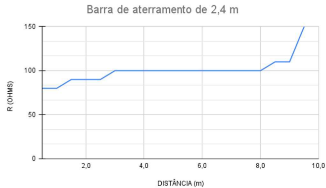
Figura 23: Resistência de aterramento do transformador isolador
