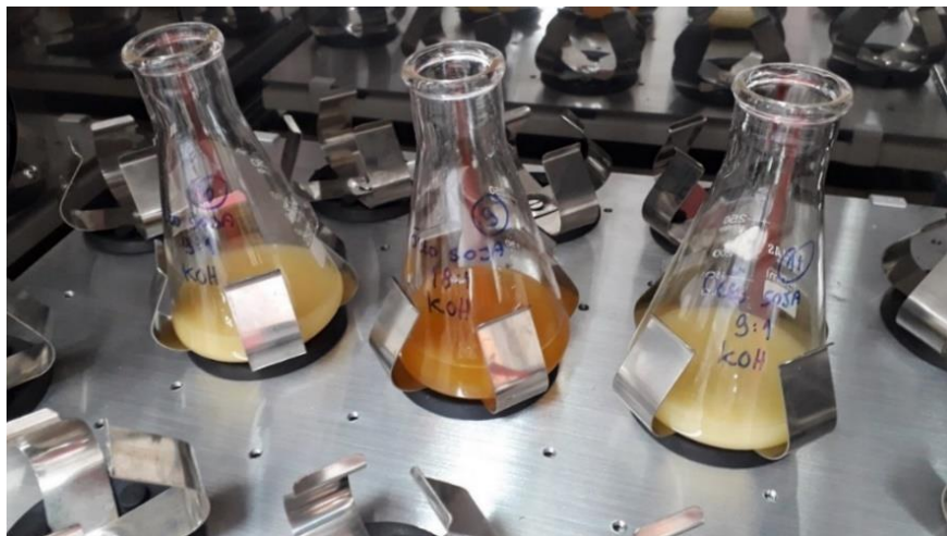
Figura 16 – Reação de transesterificação de óleo de soja a 60°C e 150 rpm
