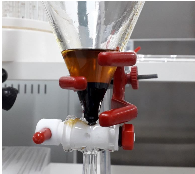
Figura 30 – Produtos da transesterificação de óleo da borra de café
