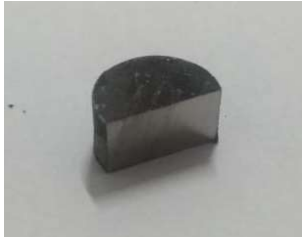
Figura 39 - Amostra temperada e cortada.
