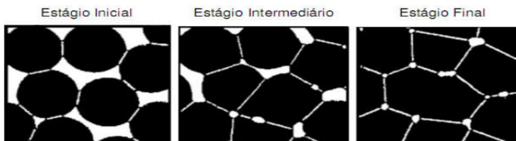
Figura 19 - Três estágios observáveis da sinterização conforme o modelo de esferas
