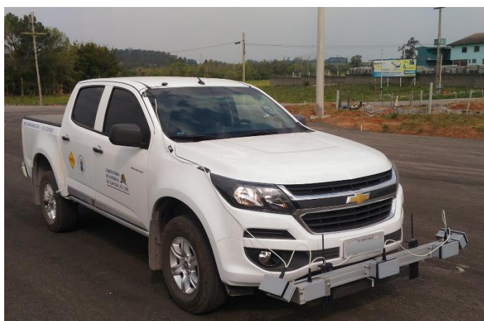
Figura 86 - Perfilômetro inercial à laser do GEPPASV
