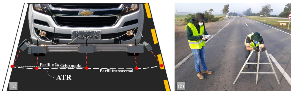
Figura 87 - Equipamentos para aferição de ATR: (a) perfilômetro inercial à laser; (b) treliça metálica
