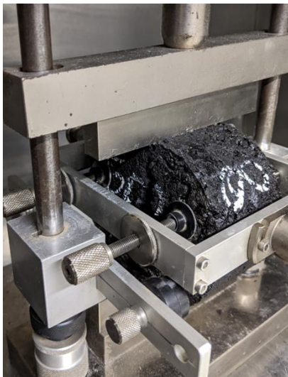
Figura 53 - Ensaio de fadiga à compressão diametral
