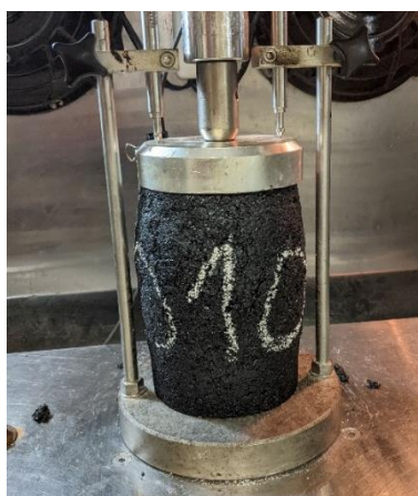
Figura 52 - Ensaio de Flow Number na amostra 010 (mistura CONV)
