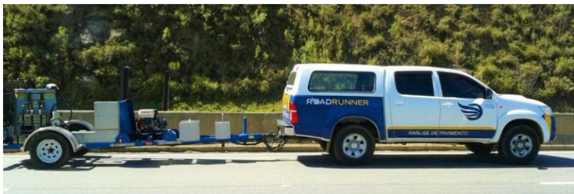
Figura 83 - Equipamento FWD utilizado nos levantamentos para recebimento da obra
