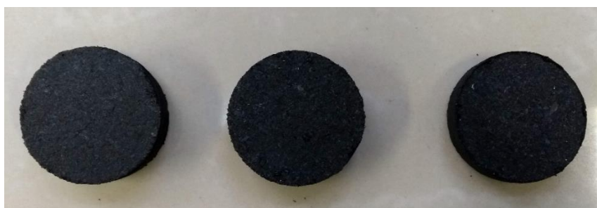
Figura 6 - Briquete produzido em laboratório através de molde cilíndrico.
