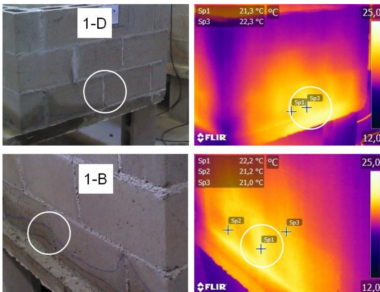
Figura 27 – Registro de temperatura nas juntas de assentamento
