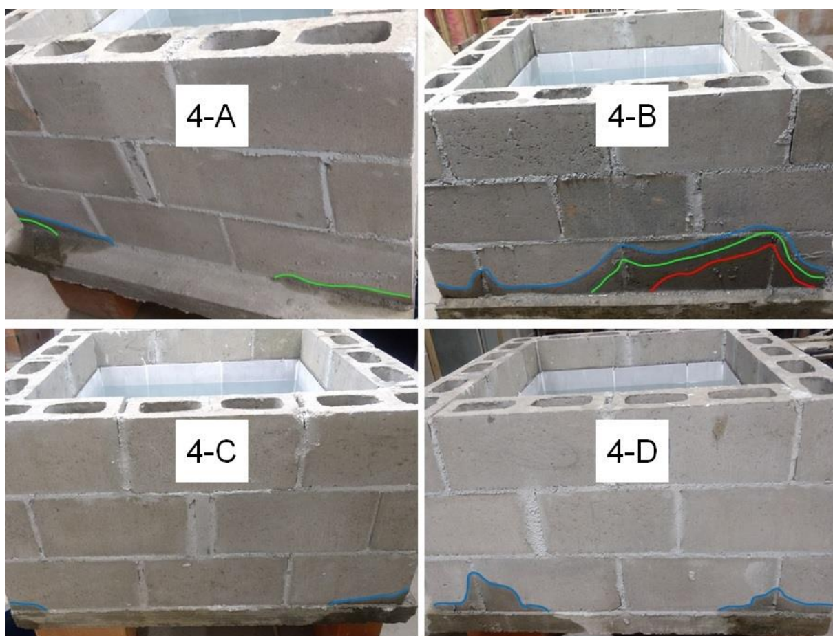
Figura 23 – Primeiros vazamentos na Caixa 4
