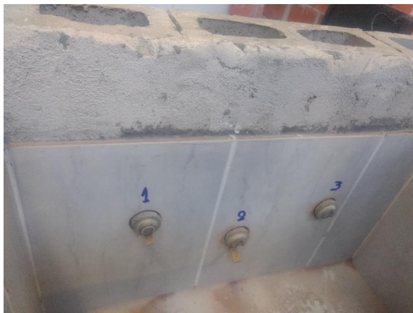
Figura 16 – Caixa 1 com as pastilhas já coladas, pronta para ser ensaiada
