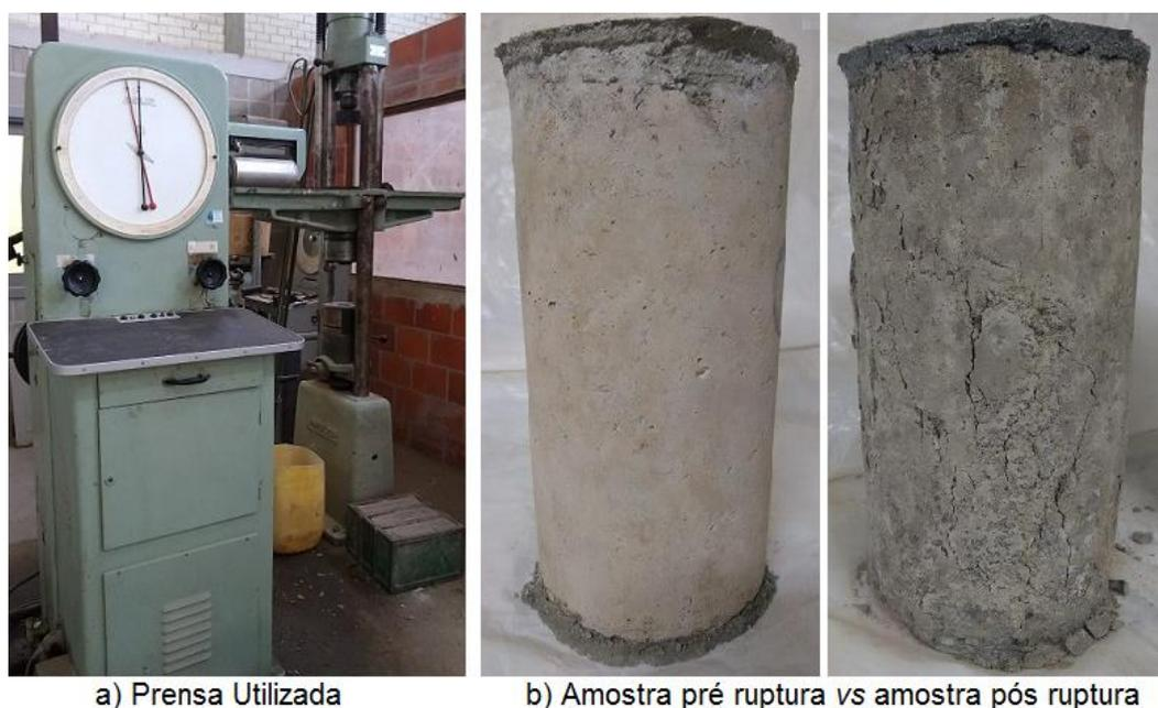
A RCS foi calculada através da divisão da carga de ruptura pela seção transversal da amostra, conforme Equação (3.3).
