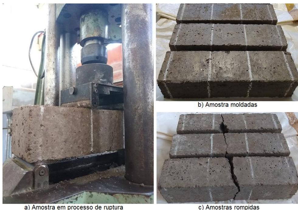
Após a aplicação do carregamento sob carga constante, foi verificado o local de ocorrência da ruptura, uma vez que a mesma deva estar localizada no terço central da viga ou no máximo à 5% do comprimento do vão. Em função do local de ruptura, aplicou-se a equação correspondente para o cálculo da resistência à tração na flexão. Utilizou-se a Equação (3.4) para rupturas localizadas no terço médio.
