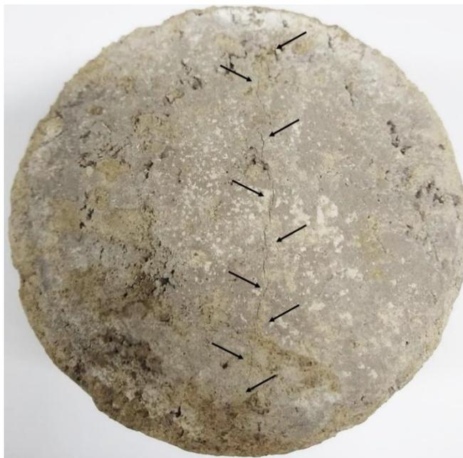
Ademais, Austroads (2012) indica que a mistura tende a entrar em equivalente granular com redução de aproximadamente 80%  $MR_{INICIAL}$ , de forma que a primeiras rupturas das amostras ensaiadas tendem a ocorrer perto da redução de 50%  $MR_{INICIAL}$ .
