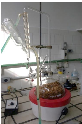
Figura 2: Método de hidrodestilação para obtenção do óleo essencial de Achyrocline flaccida .
