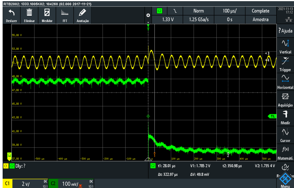
Figura 76 - Resposta da parte chaveada a redução da corrente
