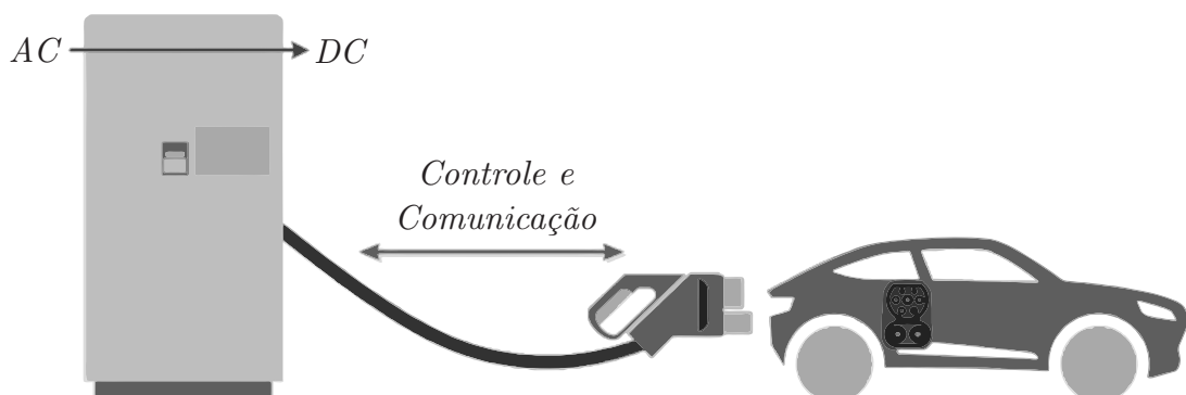
Figura 1.9 – Conexão do modo de recarga 4.
