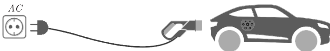
Figura 1.6 – Conexão do modo de recarga 1.
