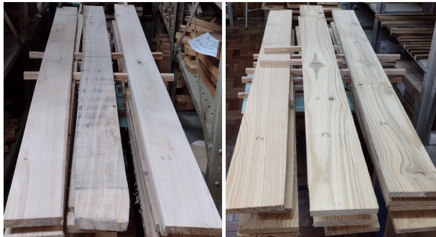
Figura 2 – Tábuas de Eucalyptus grandis e Pinus taeda em processo de secagem na câmara climatizada.
