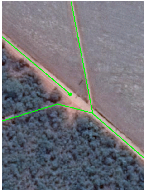
Figura 3.2 – Figura que mostra a representação vetorial errônea de uma junção juntamente com a imagem de satélite da mesma junção.
