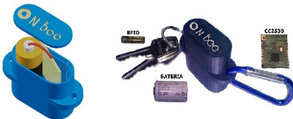
Figura 4.1 - Modelo 3D e componentes do dispositivo onBee. Fonte: CHAMON, 2014.
