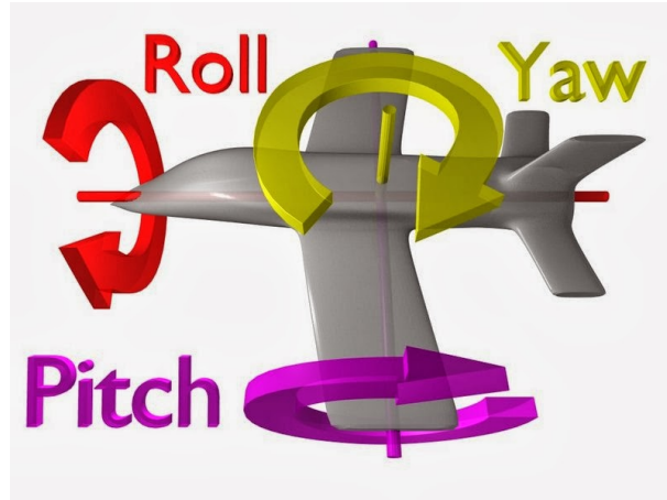
Figura 2.3 – Ilustração dos Graus de Liberdade em uma aeronave ( http://www.en.wikipedia.org/ ).
