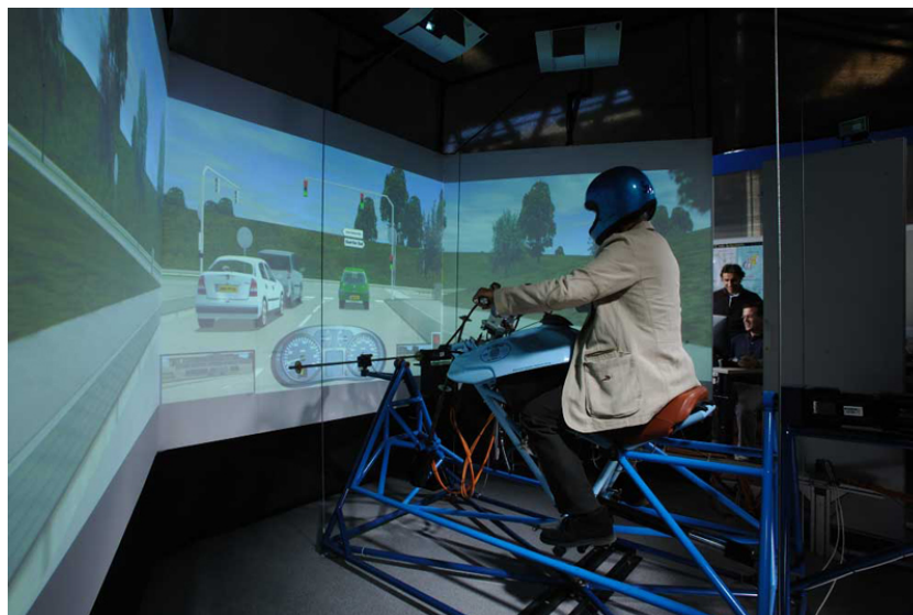
Figura 2.1 – Exemplo de imersão e interação em um simulador de motocicleta (COSSALTER, 2010, p. 224).
