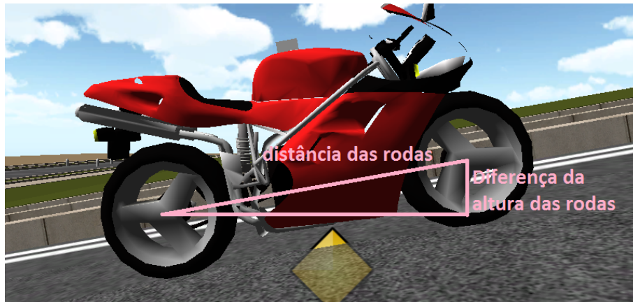
Figura 4.8 – Cálculo do Movimento Pitch da Motocicleta.
