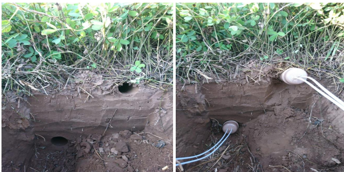
Figura 4: Instalação dos lisímetros.
