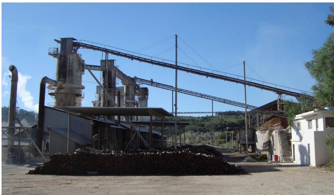
Figura 9 - Esteiras transportadoras que dão entrada da pedra aos fornos.
