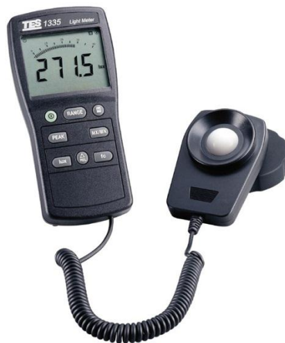
Figura 16 – Exemplo de instrumento utilizado para medição de incidência luminosa. Fonte: Repositório de imagens – Equipamentos Técnicos de Precisão e Científicos Ltda 11 .
