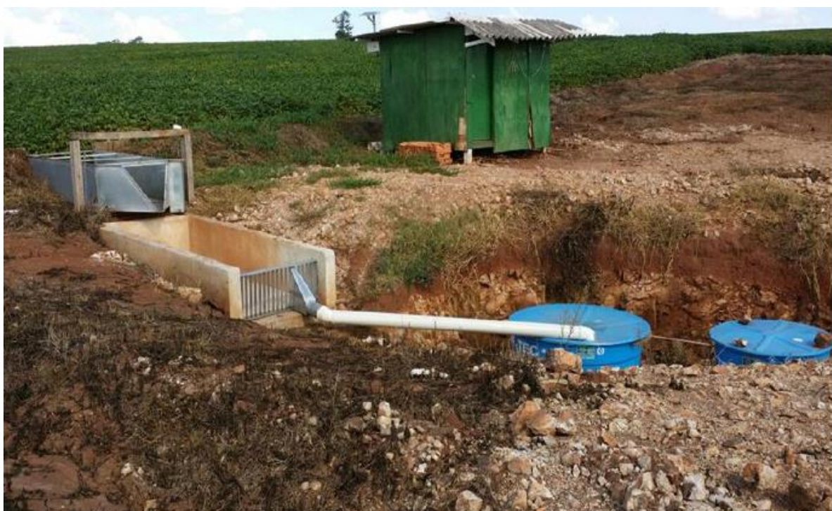
Figura 16 – Seção de monitoramento hidrossedimentométrico das bacias de ordem zero no período de 2014-2015
