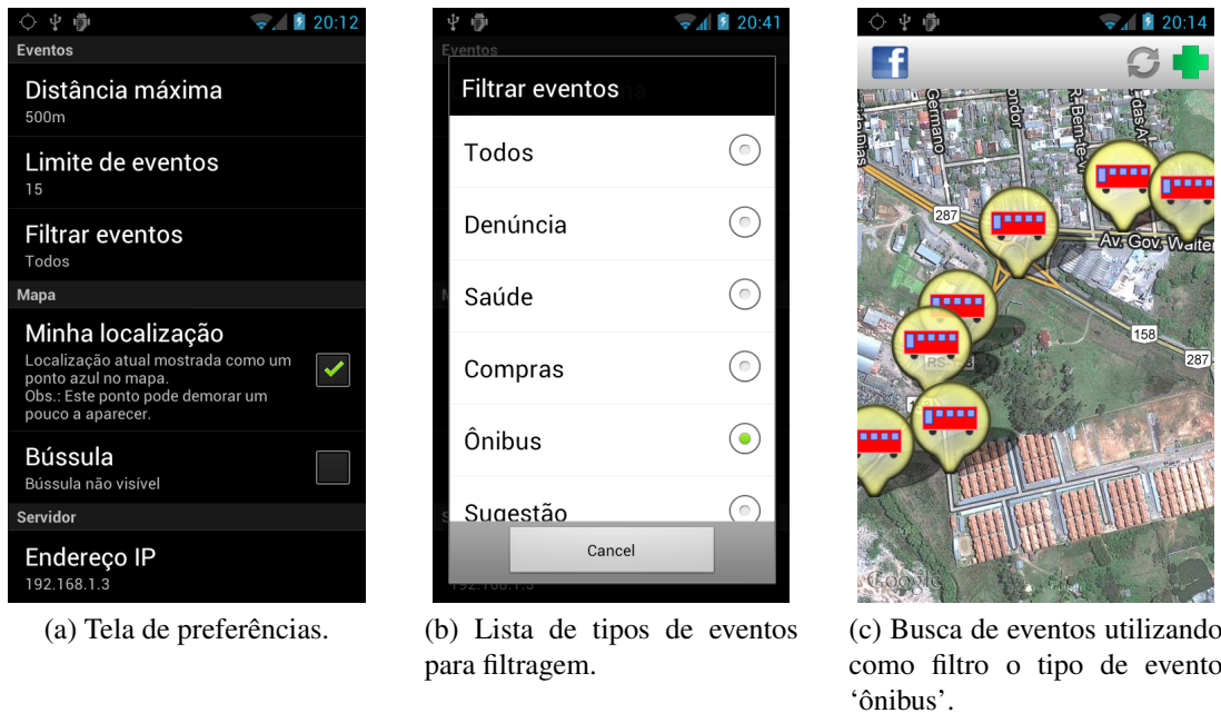
Figura 4.14 – A figura 4.14a mostra as possíveis preferências que um usuário pode determinar. Uma delas, é com relação ao filtro de busca (Figura 4.14b). Para que, se for de sua escolha, os eventos retornados sejam apenas do tipo especificado (Figura 4.14c).
