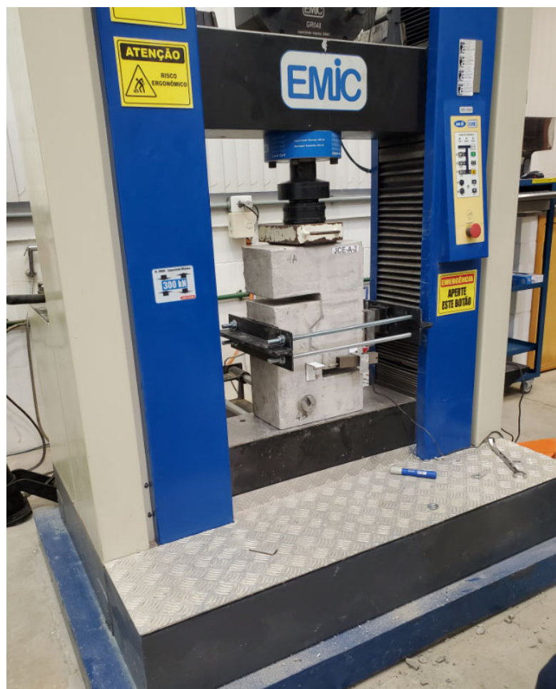
Figura 4.21 – Módulo da Máquina Universal Emic PC200CS empregado nos ensaios dos corpos de prova de juntas.
