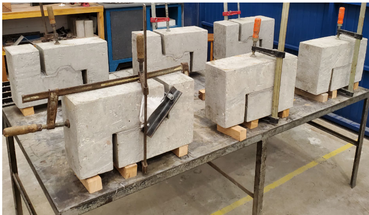
Figura 4.12 – Procedimento de união e alinhamento das juntas com adesivo epóxi
