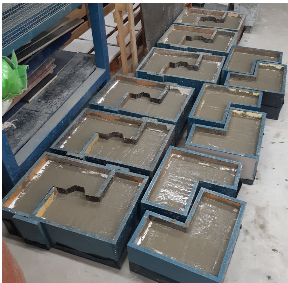
Figura 4.9 – Conclusão da concretagem da série de corpos de prova de juntas para o concreto A.
