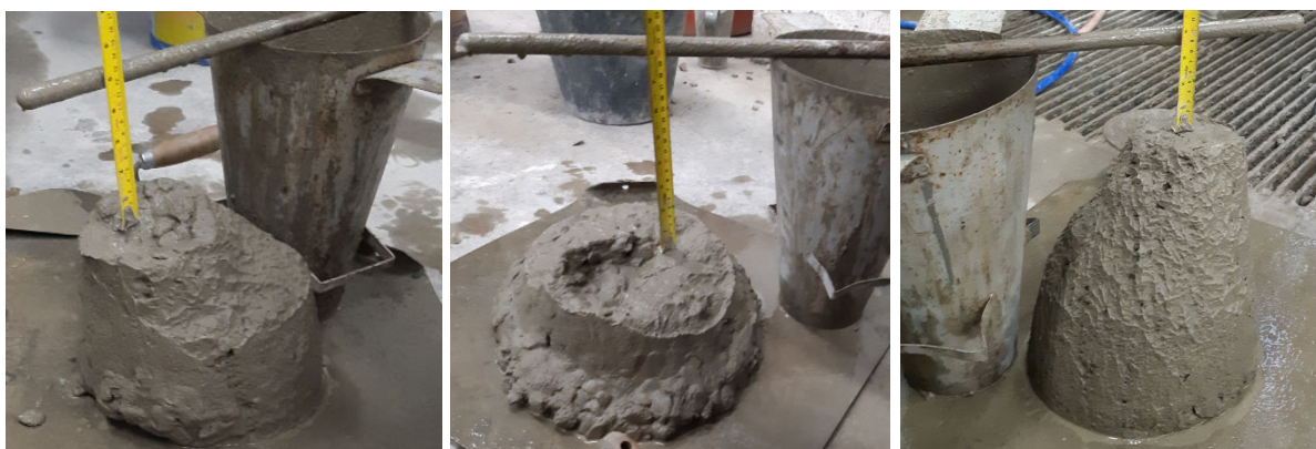
Figura 4.13 – Ensaio de abatimento do tronco de cone: (a) para a primeira concretagem, (b) para a segunda concretagem, (c) para a terceira concretagem.
