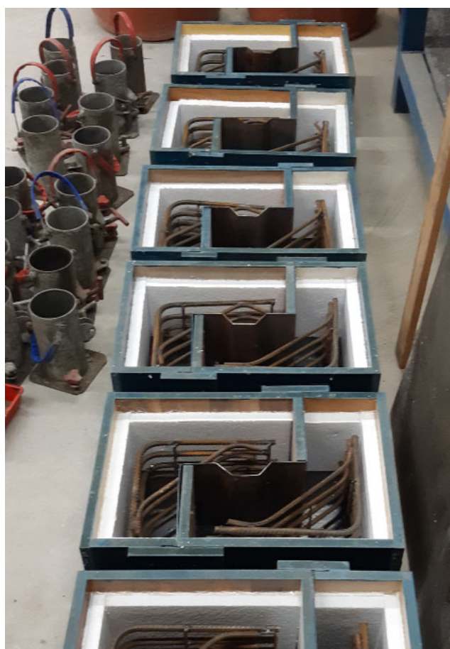
Figura 4.8 – Armaduras posicionadas nas formas das juntas com chaves de cisalhamento.
