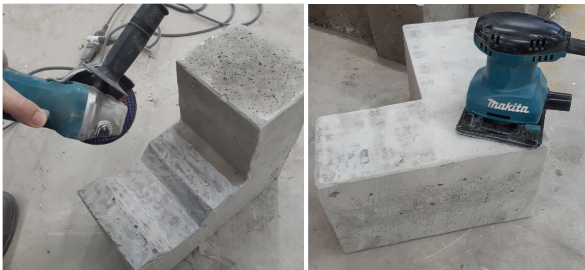
Figura 4.10 – Procedimentos de lixamento dos corpos de prova de juntas.
