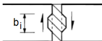
Figura 3.29 – Exemplo de largura de interface segundo o Eurocode 2.
