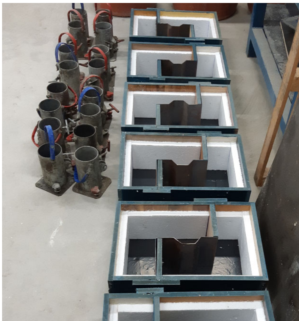
Figura 4.7 – Formas de juntas com chaves de cisalhamento preparadas para a concretagem dos corpos de prova.
