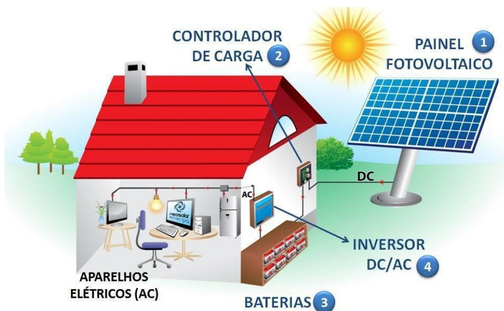
Figura 7: Ilustração representando um sistema fotovoltaico de uma residência.
