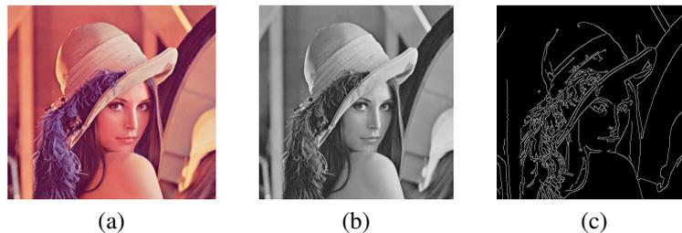
Figura 2.14: (a) Imagem original, (b) imagem em tons de cinza e (c) imagem resultante do algoritmo de detecção de bordas.
