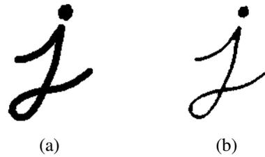
Figura 2.11: (a) Imagem original e (b) imagem após a aplicação do filtro de dilatação.
