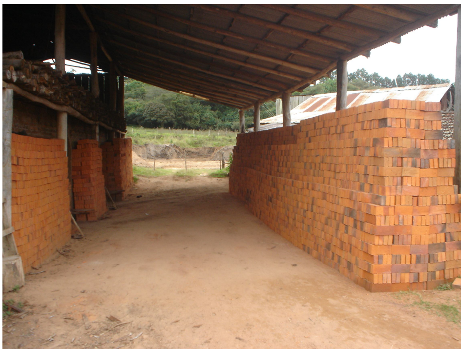
Figura 19 – Estoque de tijolos prontos dentro do galpão
