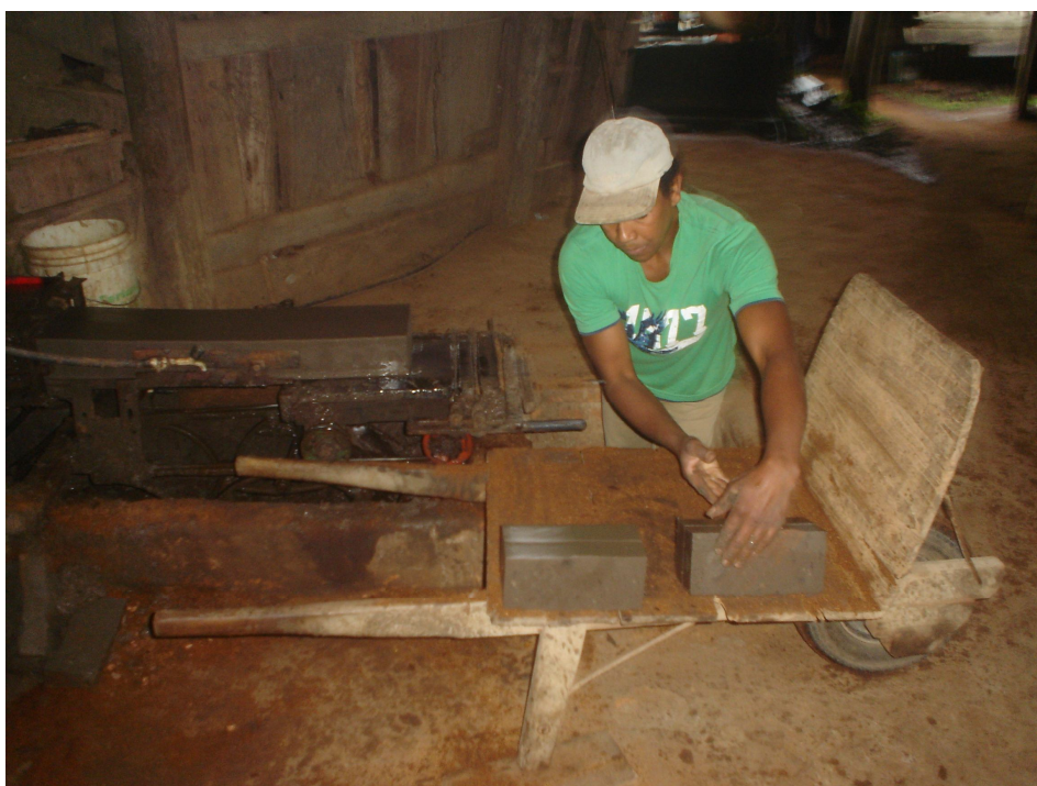
Figura 12 – “Funcionário B” cortando os tijolos e largando-os no carrinho-de-mão
