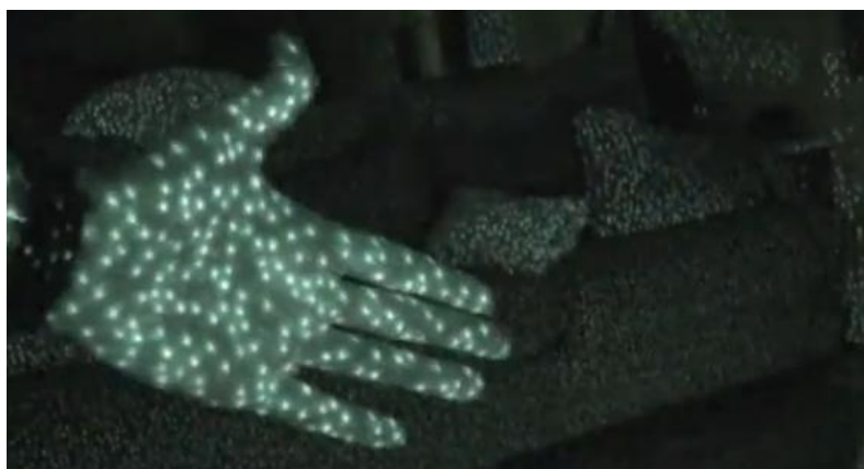
Figura 2-7 – Matriz de pontos gerada pelo projetor IR (Microsoft, 2010).
