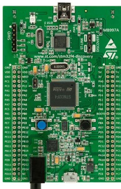
Ilustração 8: SMT32F4-Discovery; extraído de (STMICROELECTRONICS, [s.d.])
