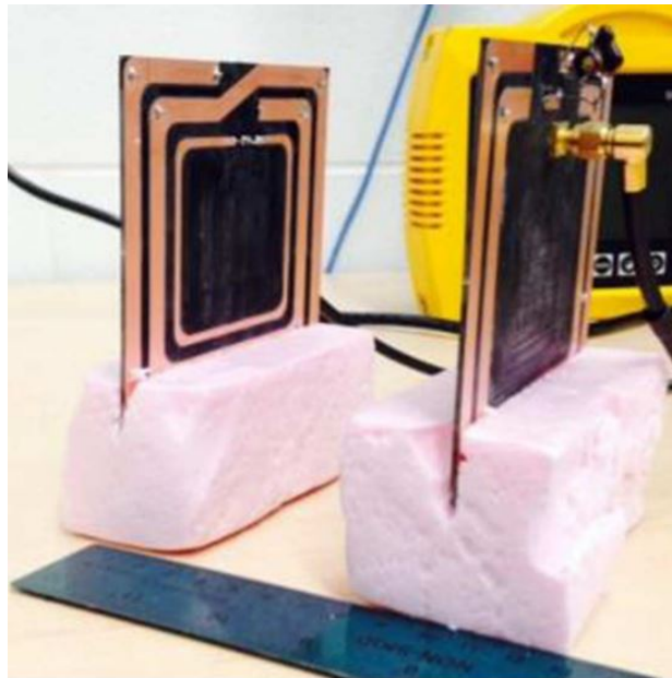
Figura 4 – Exemplo de acoplamento indutivo
