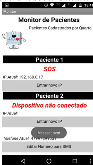
Figura 21- Aviso de mensagem enviada após o sinal de SOS ser detectado.
