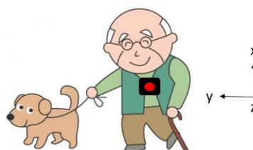
Figura 14: Posicionamento do acelerômetro levando em consideração seus eixos x, y e z.
