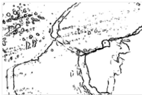
Figura 1.1: Arraste de imagens de uma mesma amostra obtidas ao microscópio ótico com diferentes ângulos de polarização da luz incidente (após processamento para evidenciar as bordas).
