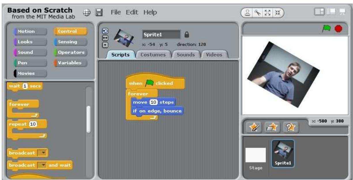
**Figura 28:** o objeto com mídia de vídeo rotacionado e redimensionado. A rotina definida pelo usuário, ao centro, indica ao objeto para, quando a aplicação iniciar, ele se mover 10 unidades de espaço e retornar quando encostar-se à borda do palco.
