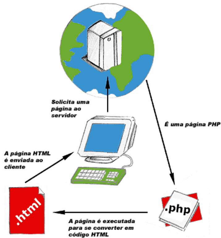
Figura 2: Integração PHP, servidor web e o retorno na forma de html
