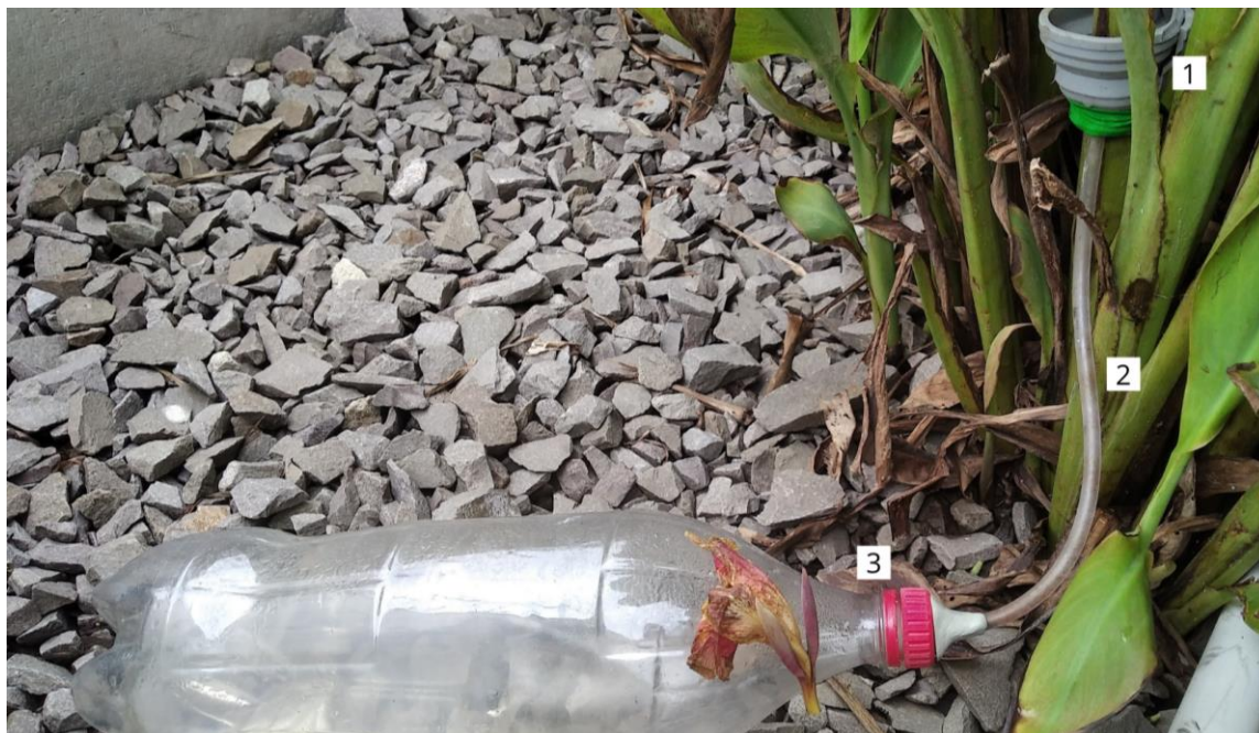
Figura 19 - Dispositivos de coleta utilizados para monitoramento de Et. 1- Coletor de funil flexível; 2- Mangueira flexível; 3- Garrafa PET para armazenamento
