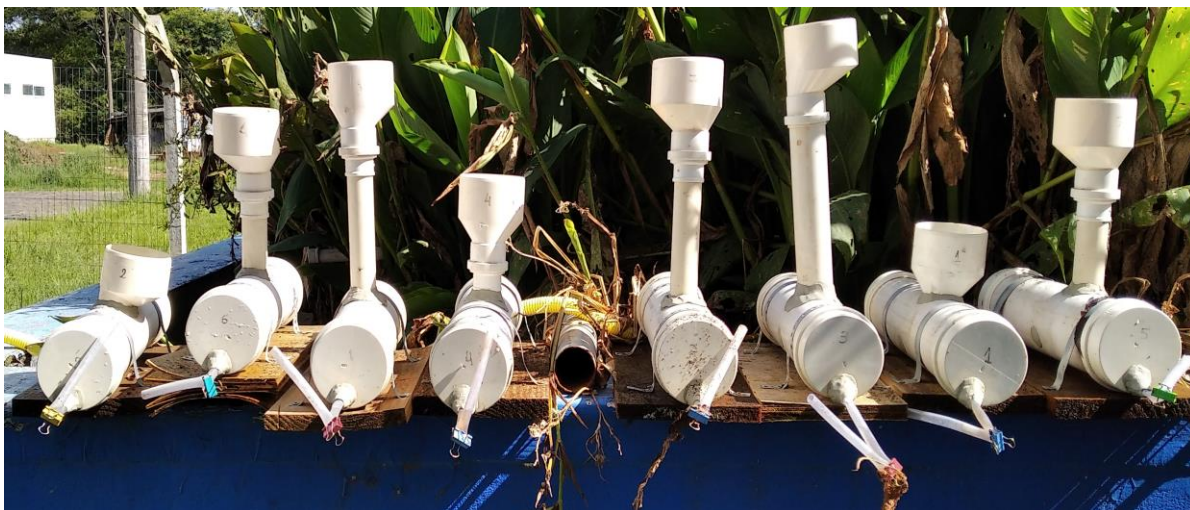
Figura 17 - Interceptômetros de diferentes alturas para monitoramento de P_i no WCV-FS
