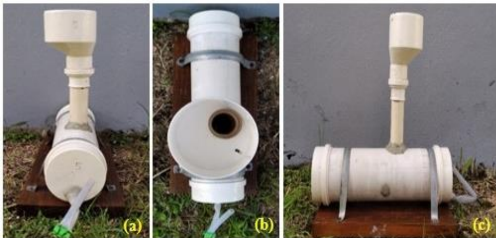
Figura 16 - Interceptômetros utilizados para monitoramento de Pi no WCV-FS. (a) Vista frontal; (b) Vista superior e; (c) Vista lateral
